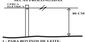
DISPOSIÇÃO DOS FIOS NA CERCA ELÉTRICA, CONSIDERANDO A ESPÉCIE ANIMAL E A CONDUTIVIDADE DO SOLO
